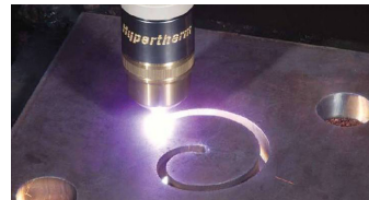
Découpe plasma double-tête haute définition jusqu'à 60 mm.
