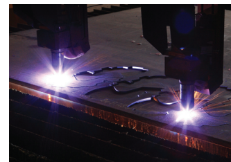
Découpe plasma double-fête Hypertem HPR 260XD Haute définition jusqu'à 50 mm.
